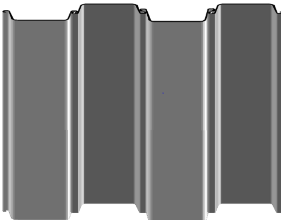
Stalowa ścianka szczelna - Larssen III n (400/280) szkic poglądowy
