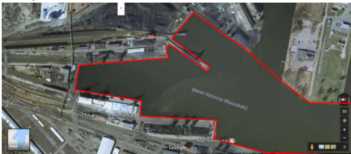
Rys.5. Główny basen Portu Basen Kaszubski jest zbyt płytki by przyjąć duże masowce. Wymaga dostosowania do rozwoju technicznego światowego transportu morskiego i bezpieczeństwa nawigacji oraz pogłębienia do 12,5 m by dostosować się do rosnących z roku na rok potrzeb transportu i zwiększyć masę przeładunkową Portu w Szczecinie.
